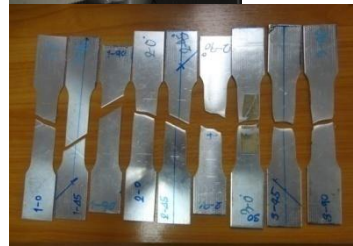
รูปที่ 7 แสดงการหาคุณสมบัติวัสดุของเครื่องทดสอบแรงดึง และลักษณะรูปร่างการเสียหายขาดของชิ้นงานทดสอบ
