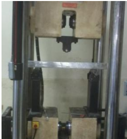
รูปที่ 2 ลักษณะชุดทดสอบแรงดัดกับเครื่องทดสอบแรงดึง
