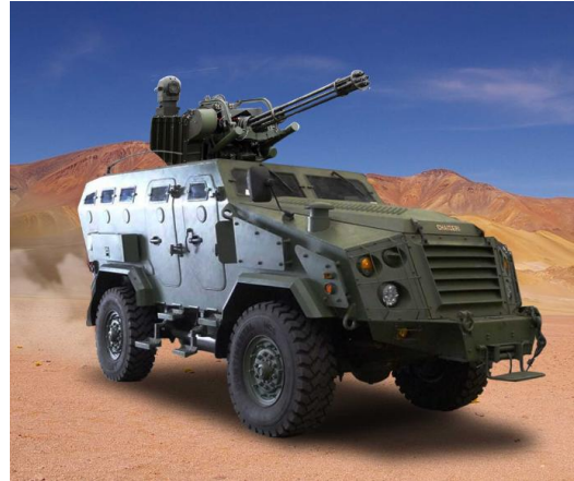
รูปที่ 12 การติดตั้งระบบบนรถหุ้มเกราะ First Win
